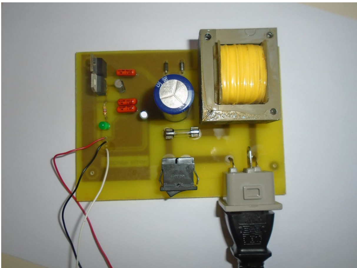
Figure II.15. Image représentative de l'alimentation 12v et 5v
