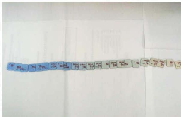
Figure IV.13 : La dégradation de la patte de papier en fonction de temps à 165°C.
