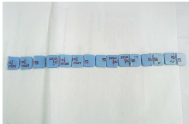
Figure IV.29 : La dégradation de la patte de papier en fonction de temps dans le diffuseur.
