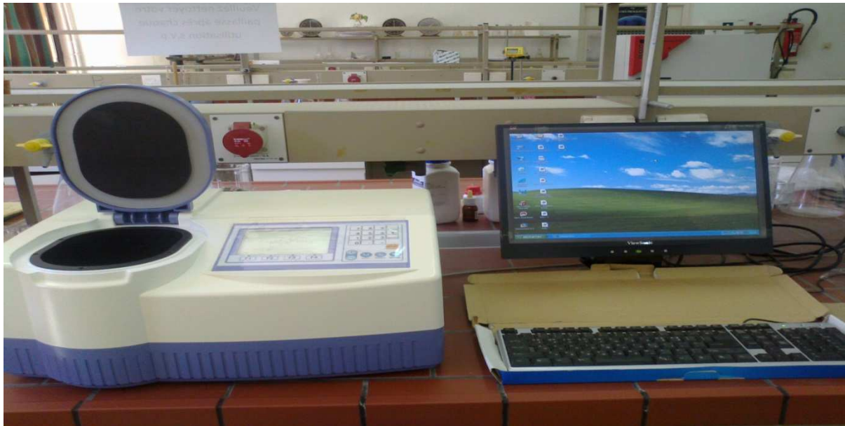
Figure .II-1 : photo de l'appareil UV-visible
