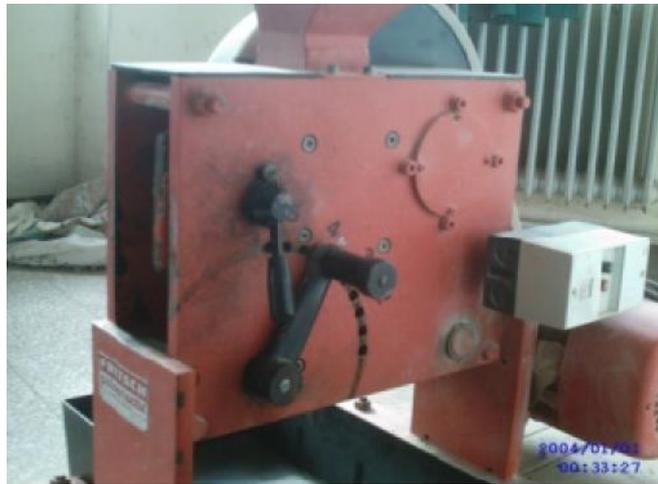
**Figure II.2.**Concasseur de type Fritsch.
