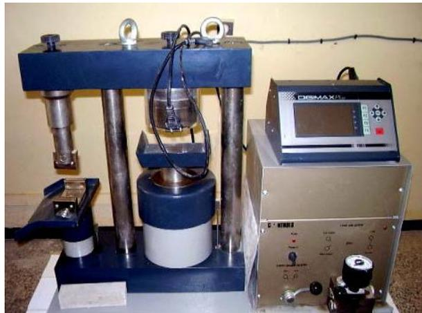
**Figure II.16.** Machine de compression et flexion sur les ciments (Control) type 65-113M1.
