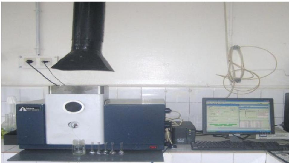
**Figure II.11.** Photo de l'appareille du spectrophotomètre d'absorption atomique
