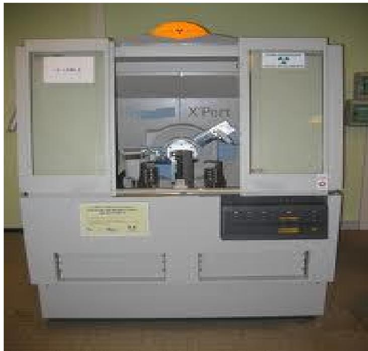
**Figure II.7.** Photo de l'appareille de DRX.
