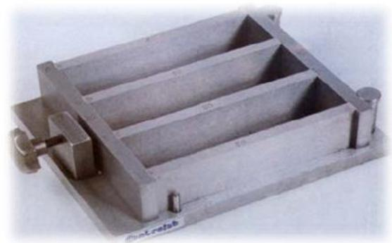
Figure II.13. Les moules utilisés pour la préparation des matrices sol cimenté.
