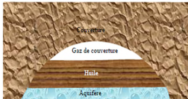
Figure II.6 : Coupe schématique d'un gisement d'huile et de gaz associé.
