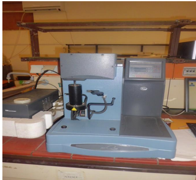
Figure 21 : L'appareillage TGA Q500.
