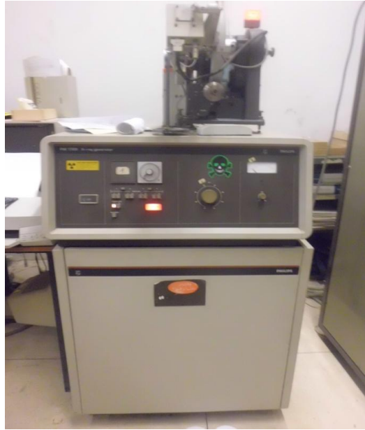
Figure 18 : La machine de DRX PHILIPS Pw 1710 difrac+.
