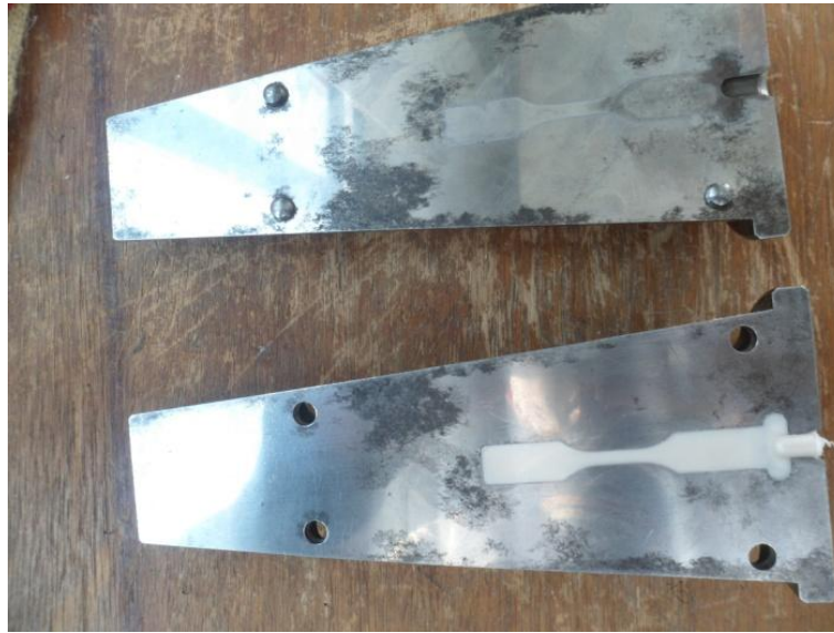
Figure 16: Vue de face de l'éprouvette dans le moule ouvert.
