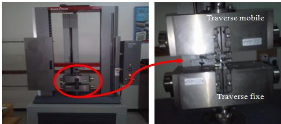
Figure 24 : Machine de traction de marque Zwick/Roell Z010.
