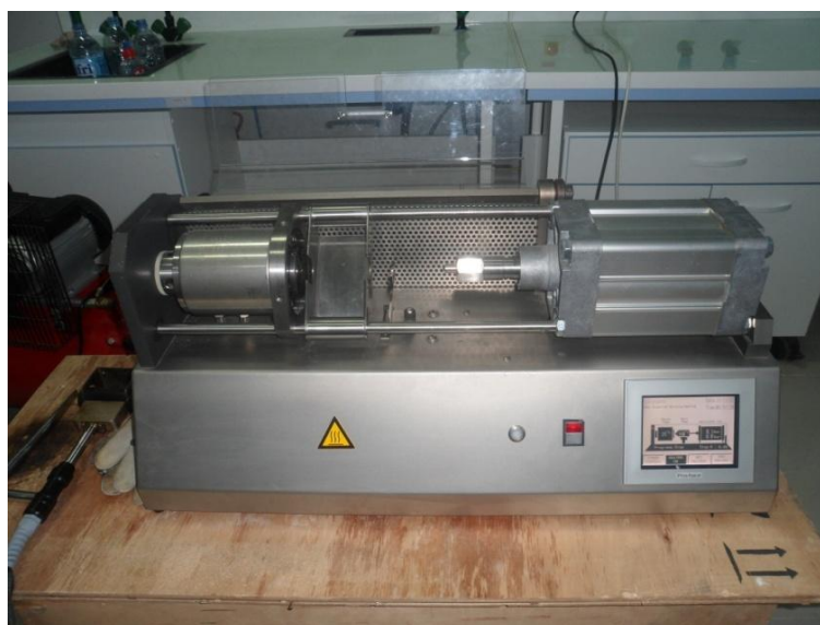
Figure 15 : Représentation du fourreau (à gauche) et la presse à injection.
