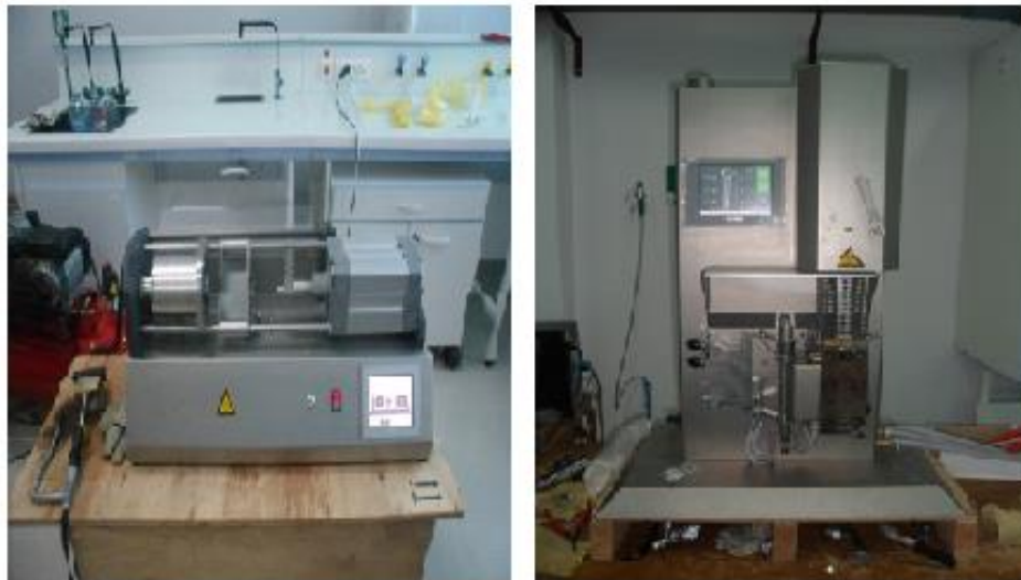
Figure. 16 : Photos de l'extrudeuse et la presse à injection
