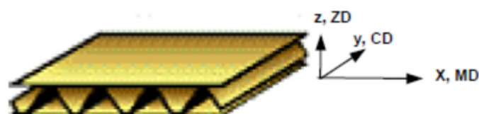
Fig.8 : Carton ondulé à paroi simple [18].
