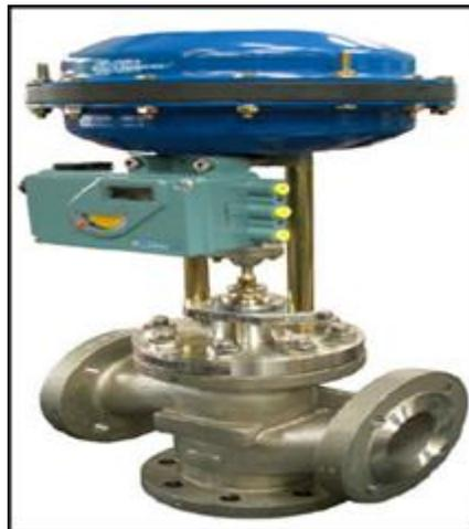
Figure II.17. La vanne de régulation à trois voies.
