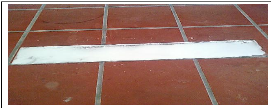
Figure 7 : Immobilisation de TiO 2 sur des plaques en verre.
