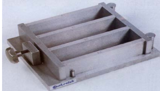
Figure III-3- Les moules utilisés pour la préparation des matrices cimentaires.
