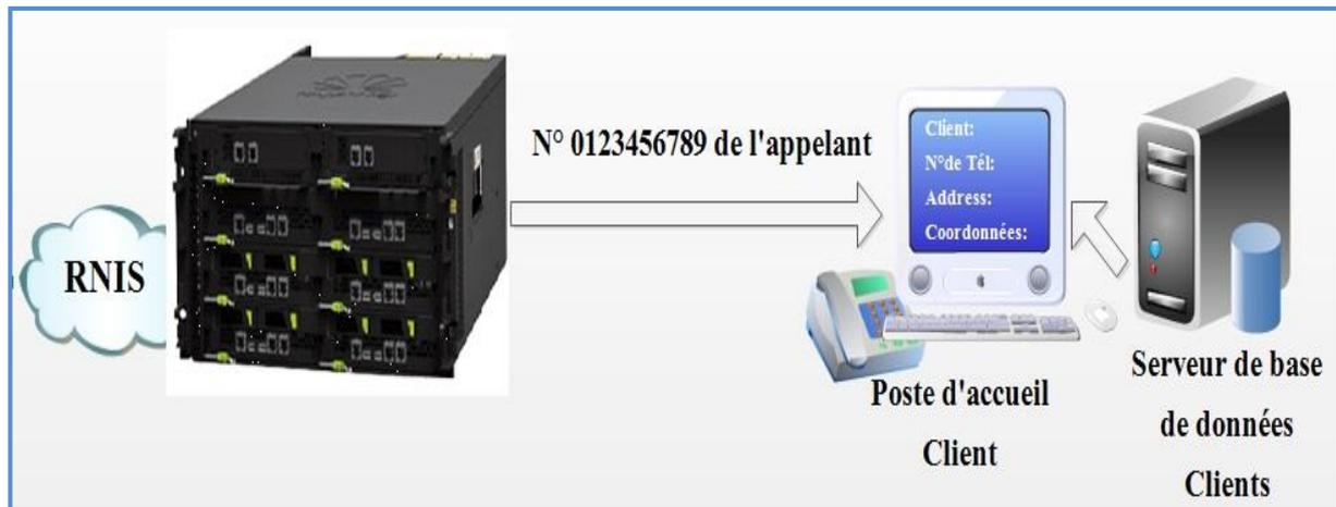
Figure II.4- Principe d'un accueil fondé sur le CTI.
