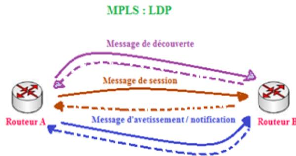
Figure 2.13: Principe de fonctionnement d'un LDP
