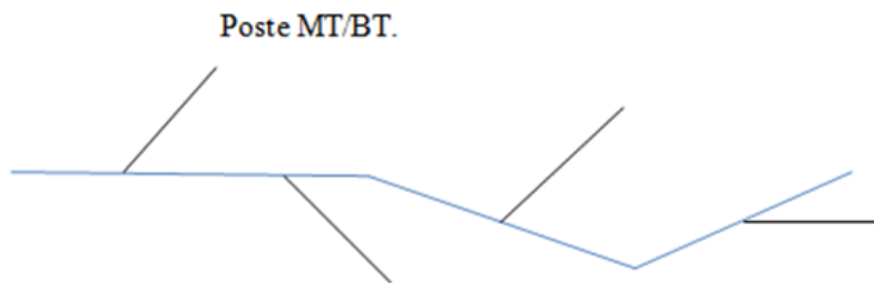
FIGURE 1.5 – Réseau de distribution radial.
