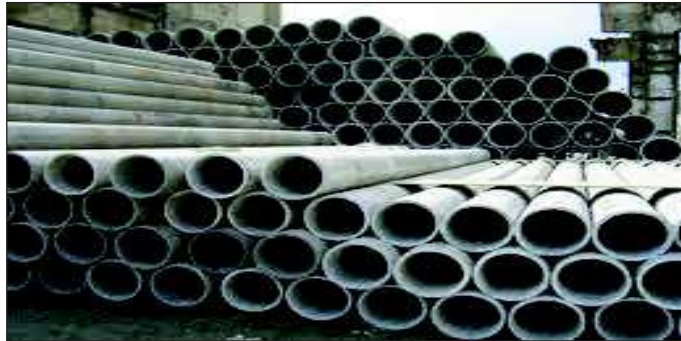
Figure (I-8): Conduites en Amiante-ciment ;
