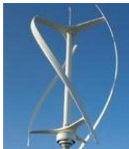
**Figure-I.2.** Éolienne à axe vertical [1]
