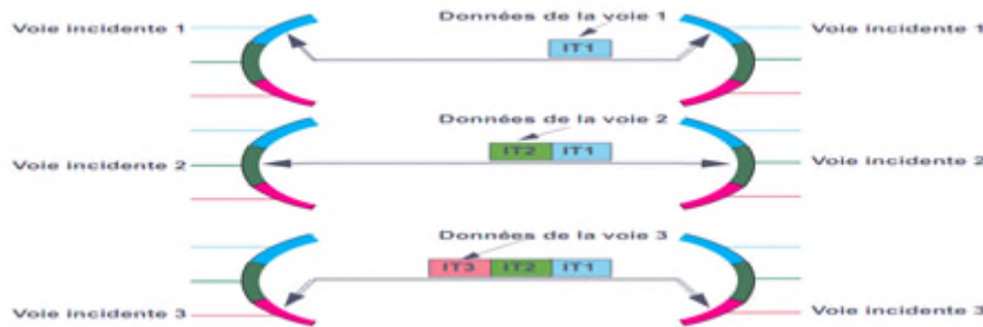
Fig 2.4 : Principe du multiplexage temporel.
