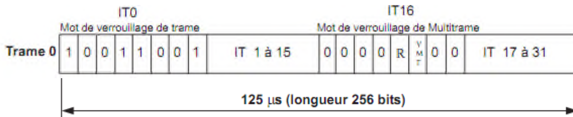
Fig2.7 : Trame MIC et information de signalisation.
