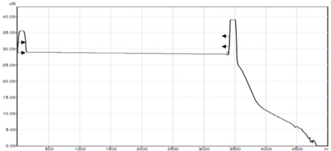
Fig 3.5 : Trace OTDR de la liaison RTC-CA.
