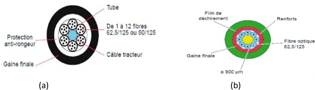
Fig2.14 : La structure libre (a), la structure serrée (b) d'un câble à fibre optique
