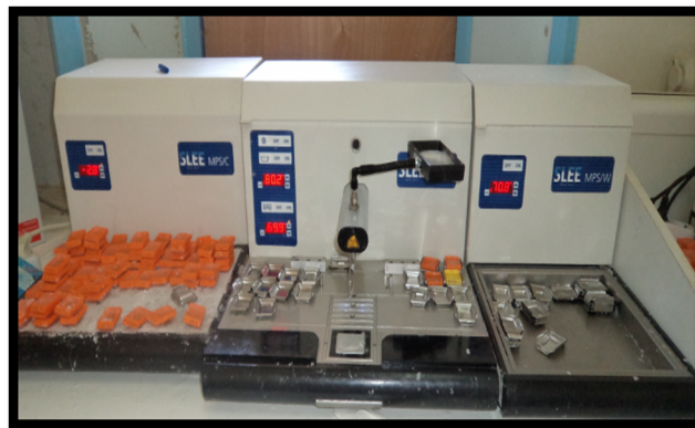
Figure 16 : Appareil d'enrobage et confection des blocs
