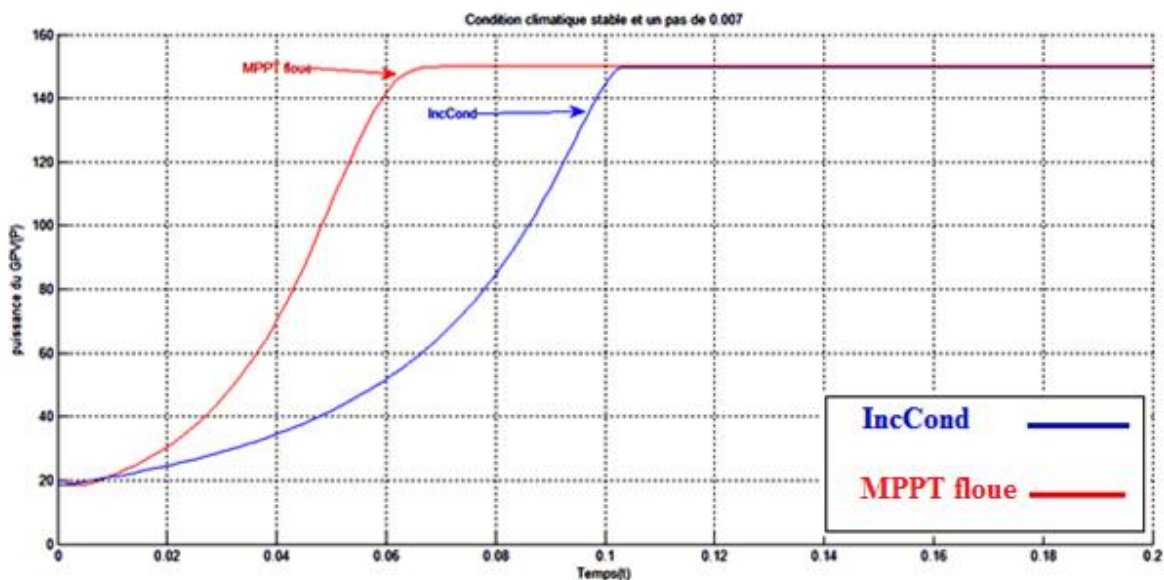
Figure 4.11 : Puissance en sortie du GPV pour un pas de perturbation de 0.007 (Pour la méthode IncCond)
