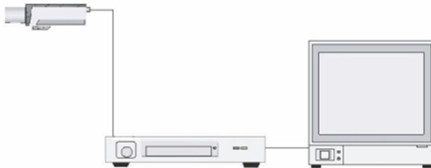
**Figure II.9 : Installation vidéosurveillance avec magnétoscope**
