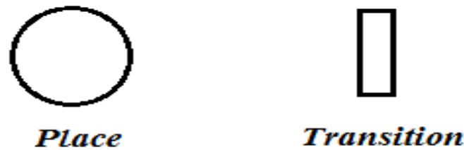
FIGURE 3.1 – Les composants d’un réseau de Petri
