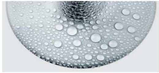
Fig. II.3 : hydrophobicité d'une silicone
