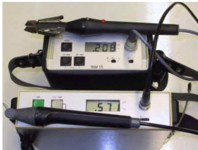
Fig. III.1: Photo d'un conductimètre à sonde mobile.
