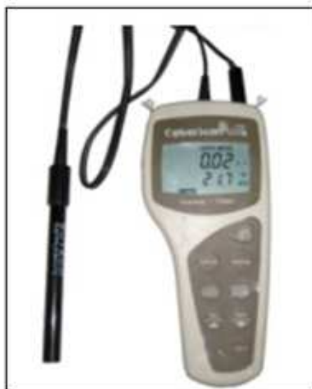
Fig. IV.3 : Appareil de mesure de conductivité volumique
