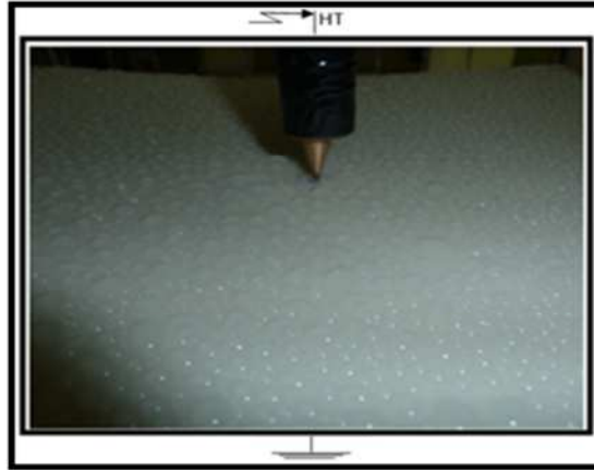
Fig. IV.11 : Vue de la face HT avant la mise sous tension de l'écran avec perte partielle d'hydrophobie
