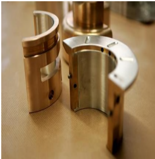
Figure II.1 : Coussinets d'une ligne turbine
