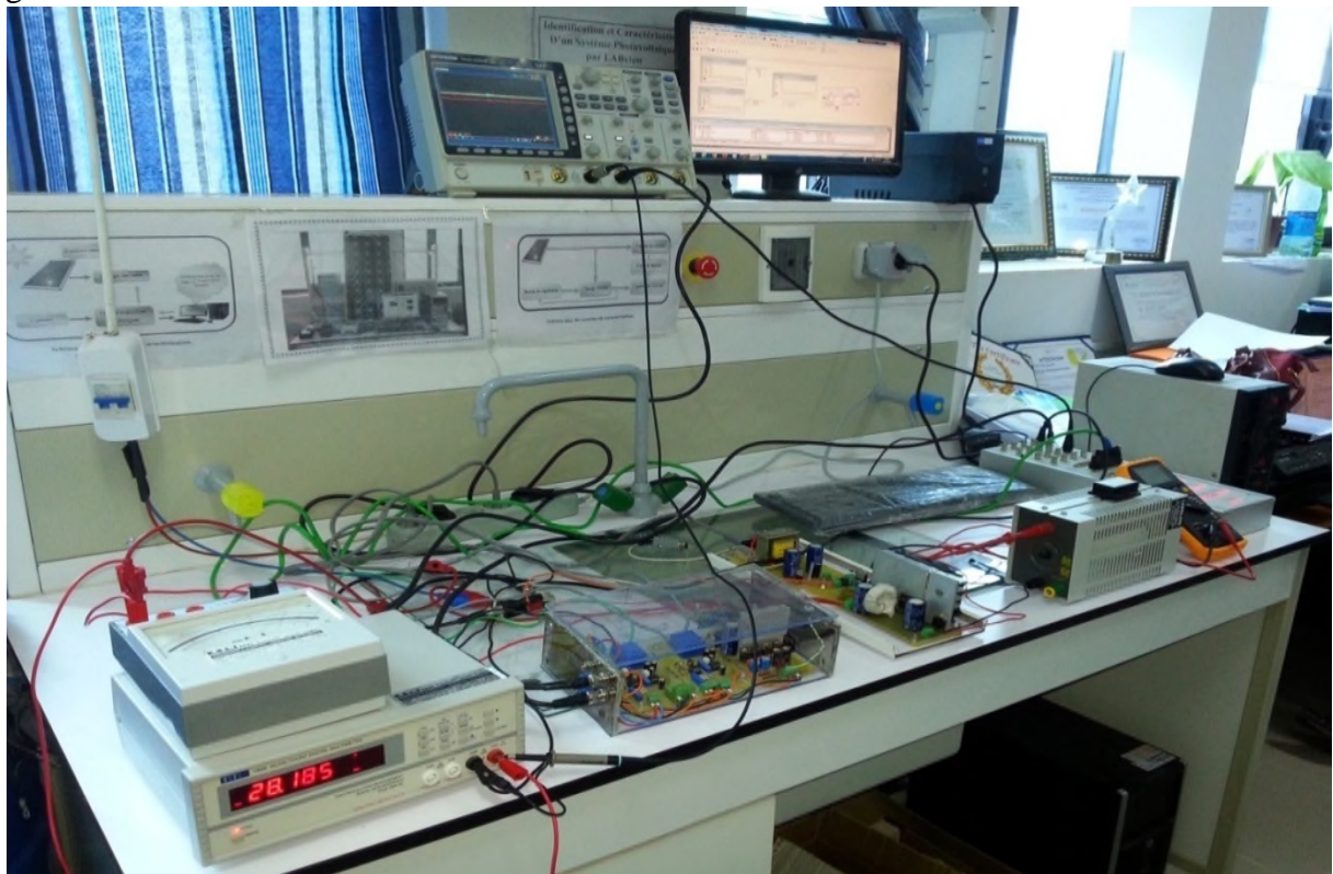
Figure IV.11. Système d'implémentation sous dSPACE DS 1104.
