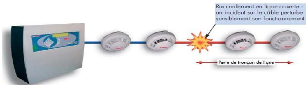
**Fig.IV.6.** Schéma d'une installation pour un raccordement ouvert.
