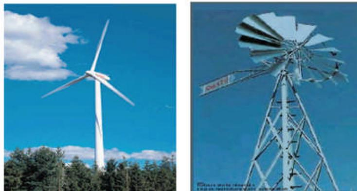
Figure (I.14) : éolienne à axe horizontal
