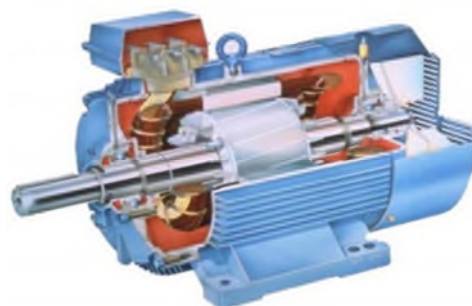
Figure II.2 Différents éléments constitutifs de la machine asynchrone
