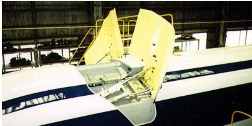
**Fig. I.27.** Panneaux de freinage aérodynamiques
