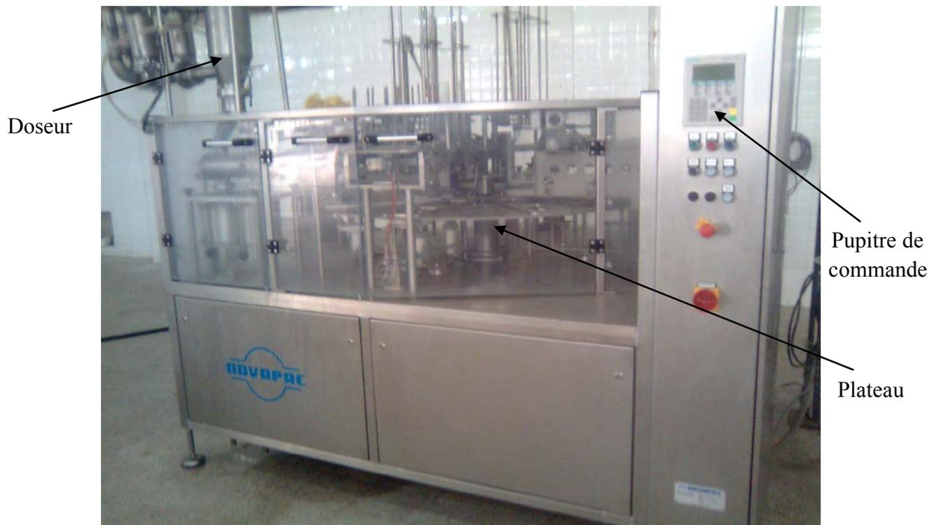
Figure 1.3 : Vue de face de la machine de remplissage NOVAPAC RP 200-2
