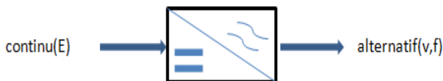
Figure I. 1: schéma bloc représentatif d'un onduleur.
