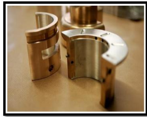
Figure II.5. Coussinets d'une ligne turbine
