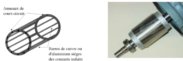
FIG. 1.5 – Schéma de principe d'une cage d'écureuil.
