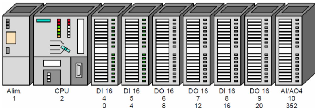
Figure III.4 : Vue générale de l'automate S7-300[15]
