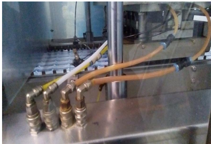
figII.2 :Circuits de refroidissement
