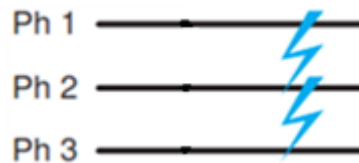
Figure IV.13: Court-circuit entre trois phases
