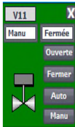
Figure IV.25 : Vue commande vanne.
