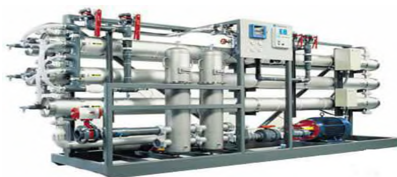
Figure I.3 : Exemple d'un osmoseur industriel.
