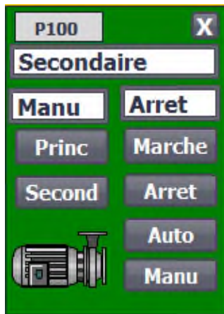
Figure IV.24 : Vue commande pompe.
