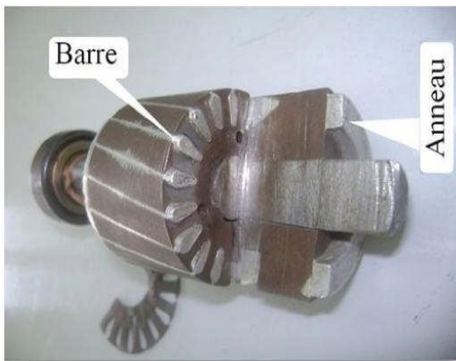
(a) Coupe d'un rotor à cage d'écureuil en aluminium
