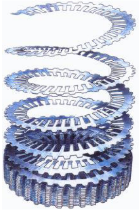
Figure II.26 : Processus slinky, construction du stator en hélice
