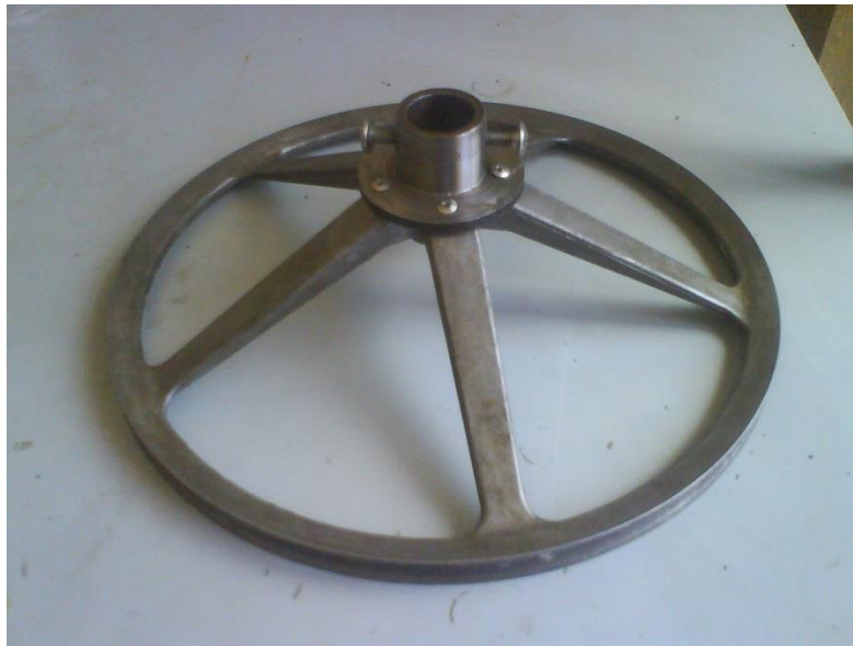
Figure III.8 : Poulie montée sur la bague de fixation
