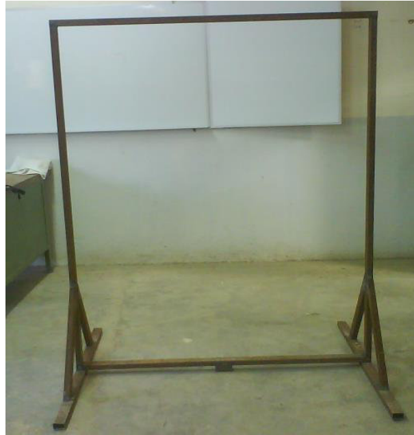
Figure III.1 : Support de l'éolienne
