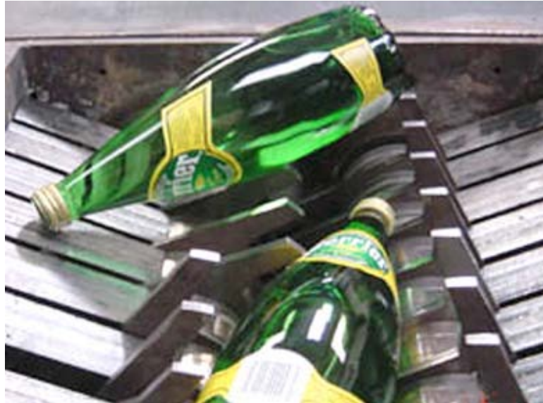
Figure III.3 : broyeur pour les bouteilles de verre.
