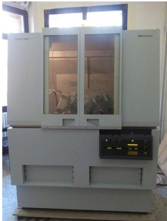
**Figure II-7:** Diffractomètre XPert PRO PANalytical (Université A/Mira, Bejaia , Algerie).
