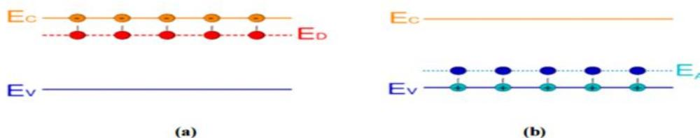
**Figure I-4:** Représentation du niveau énergétique de l'élément dopant (a) Dopage de type n,
