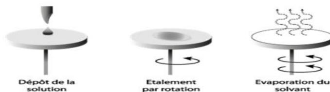
**Figure I-11:** Principe de la méthode "spin coating" ou "centrifugation" [36].
