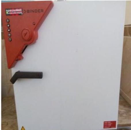
**Figure II-2:** Etuve utilisée pour séchage.
