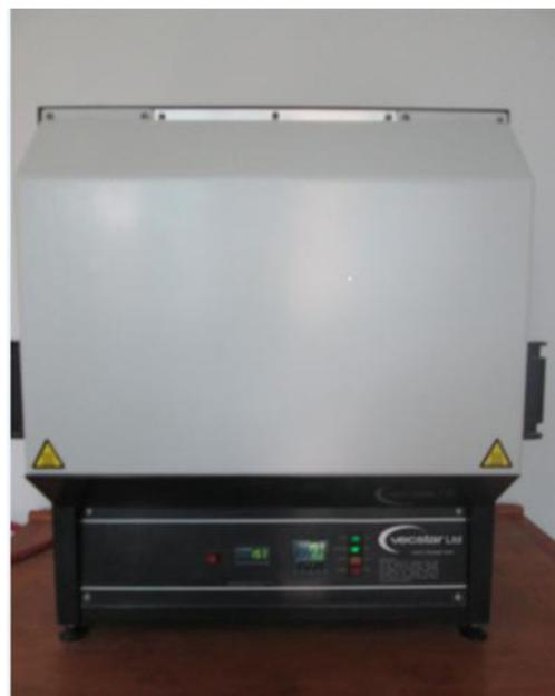
**Figure II-5:** Four utilisé pour le recuit.
