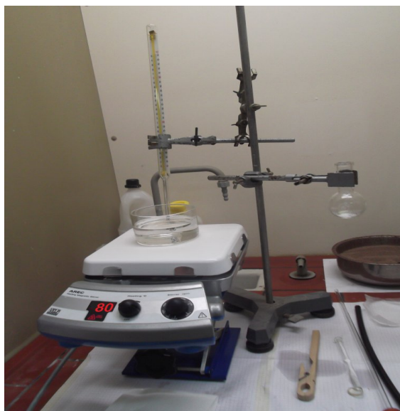
Figure II.2 : Montage de la réaction multicomposant de Biginelli
