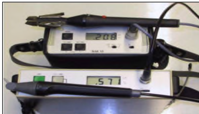
Fig.3. 2: Photo d'un conductimètre à sonde mobile
