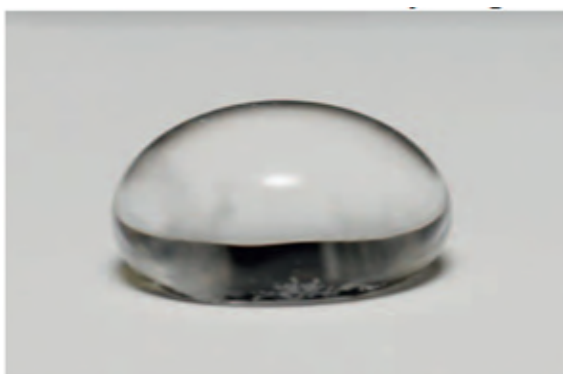
1) Goutte d'eau sur un revêtement de silicone polluée
