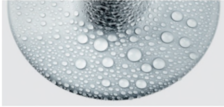
Fig.2. 8 : hydrophobicité d'une silicone
