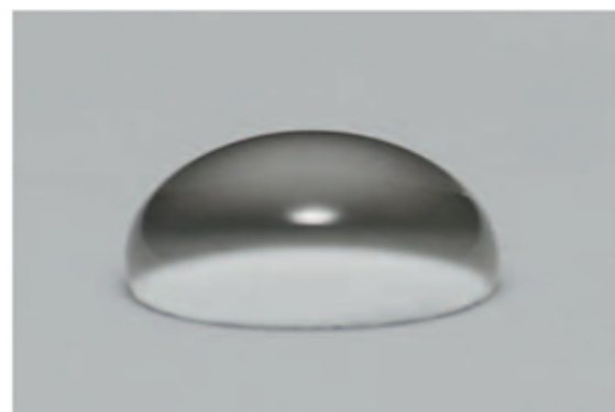
2) Goutte d'eau sur un revêtement de silicone nettoyée
