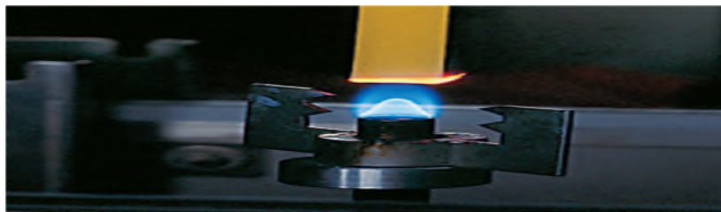
Fig. 2. 9: tenue au feu de silicone
