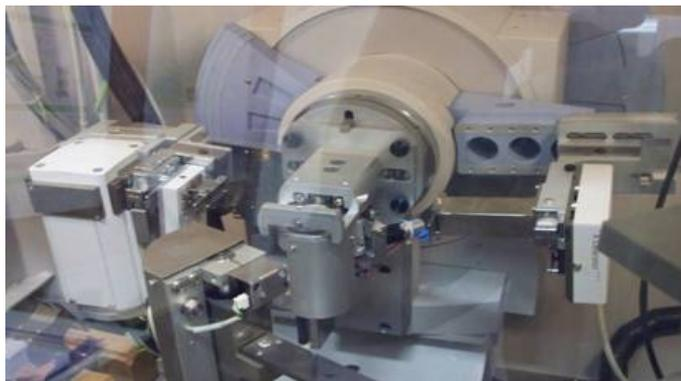
FIGURE 2.8 – Diffractomètre Bragg-Brentano
