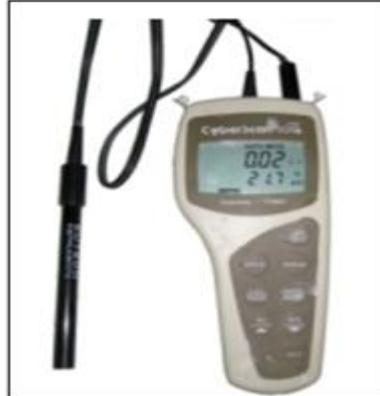
**Fig. 4. 4:** Appareil de mesure de conductivité volumique (Conductimètre)
