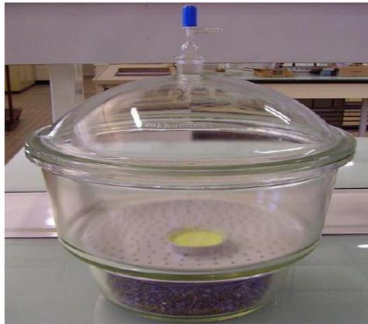
**Fig. 4. 5:** Photo montrant un dessiccateur
