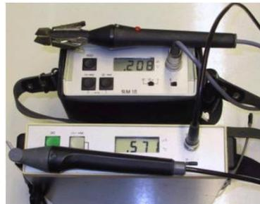
**Fig. 3. 5:** Photo d'un conductimètre à sonde mobile
