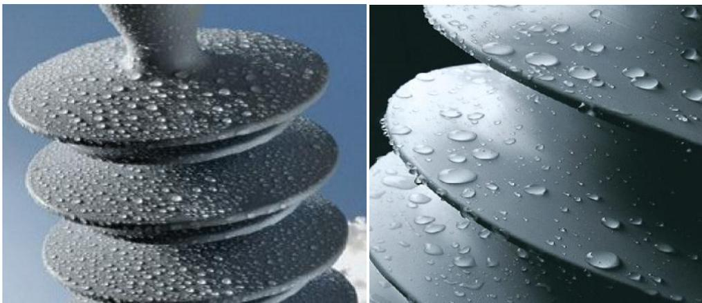
**Fig. 2. 8:** Hydrophobicité d'une silicone
