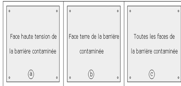
**Fig. 1. 12:** Variantes de contamination des surfaces hydrophobes et hydrophiles de la barrière
