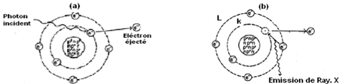
Figure I.1. Effet photoélectrique : (a) Ejection d'un électron ; (b) Réarrangement électronique et émission de rayons X.
