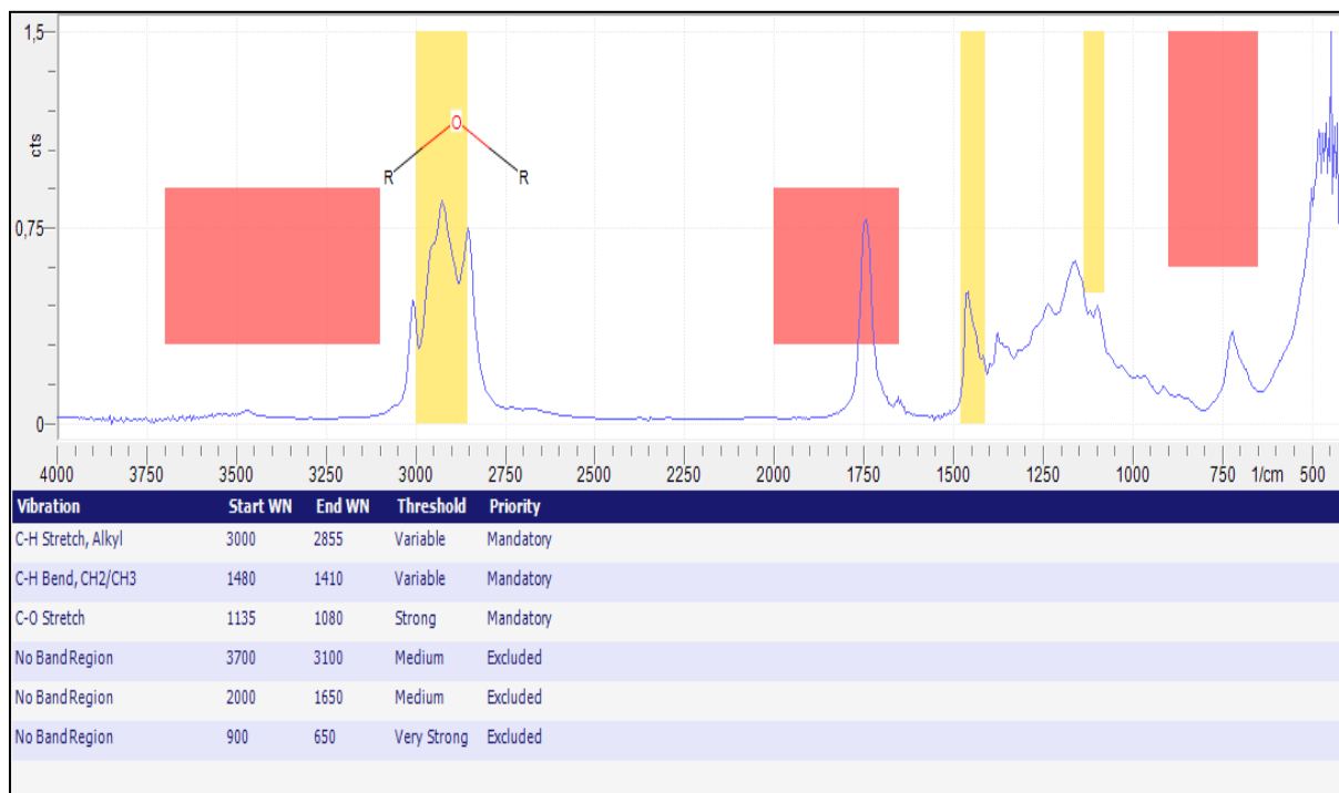
Les vibrations correspondantes des groupements fonctionnels formant les esters et les composés carbonyles dans un spectre IR
