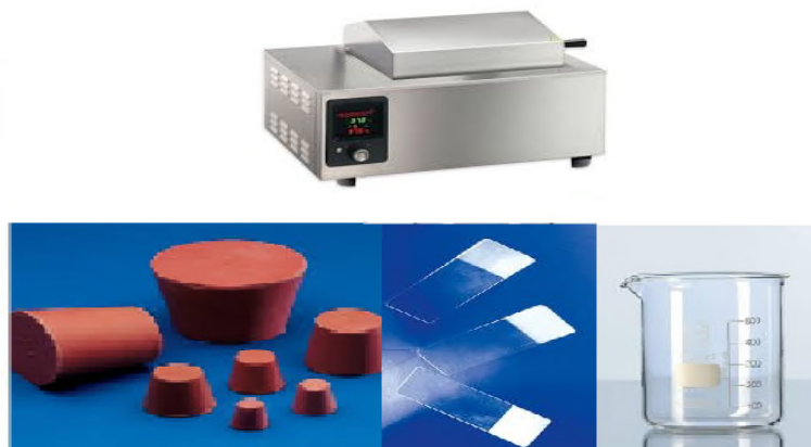
Fig.11 : Dispositif expérimental de la technique CBD
