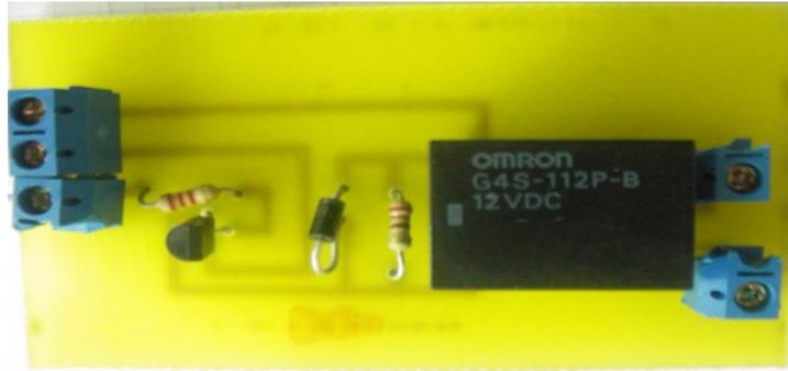
**Figure III.14 :** Image réelle du circuit de puissance
