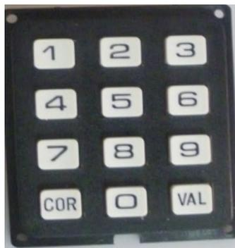
Figure III.7 : Clavier matriciel
