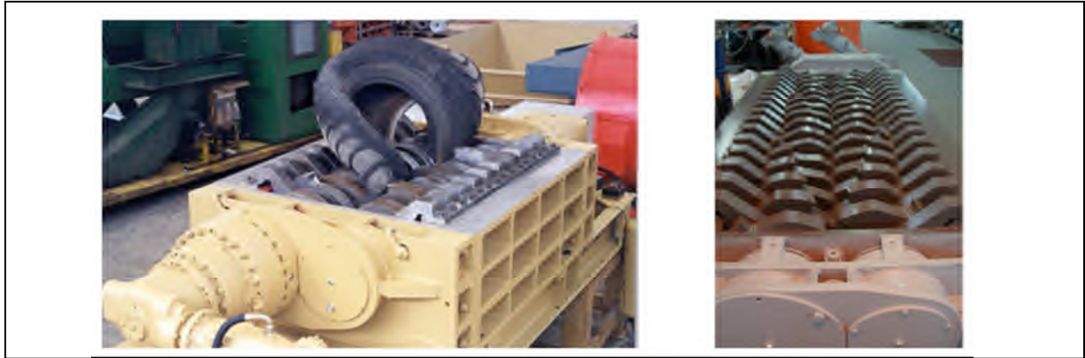
Figure II.4 : Déchiqueteur à cisaille rotative à 2 axes
