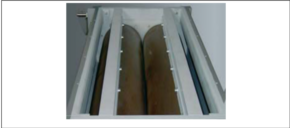
Figure II.2 : broyeur à cylindres
