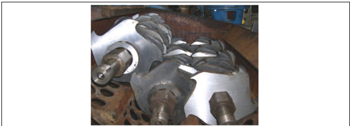
Figure II.5 : Déchiqueteur à cisaille rotative à 3 axes à grille de calibrage
