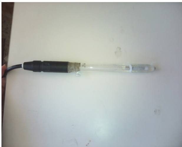
Figure II-3 : Electrode de référence.
