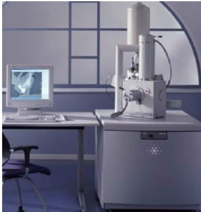
Figure II-8 : Photo d'un microscope électronique à balayage.
