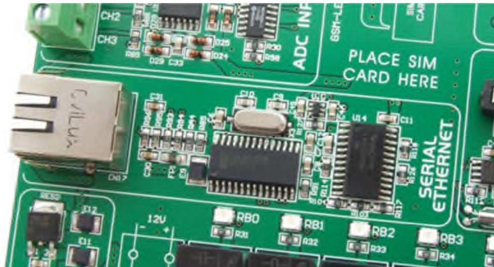
**Figure III.7** Module Ethernet.
